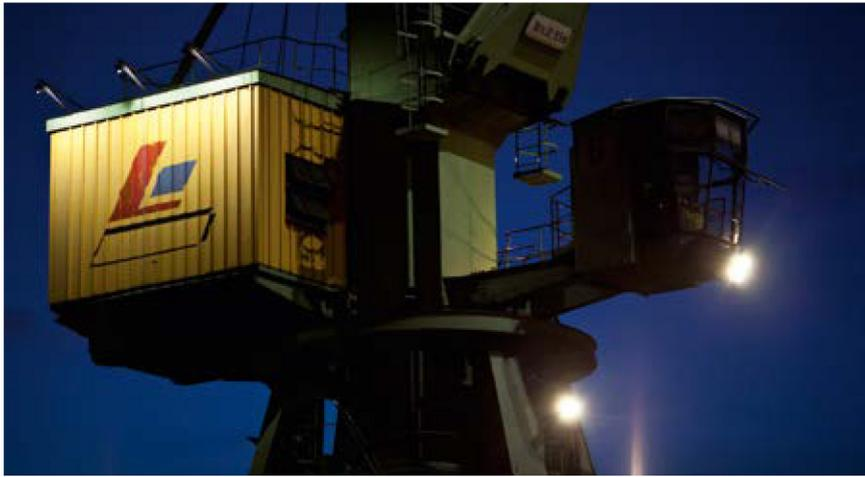
**Abb.:** Wartungsfrei und energiesparend sind die neuen LED-Leuchten am Portalwippkran 5 im Stadthafen Lünen. 13 Fluter und Kompaktstrahler kommen seit Oktober 2014 zum Einsatz und sorgen für eine optimale Ausleuchtung der Arbeitsumgebung.
