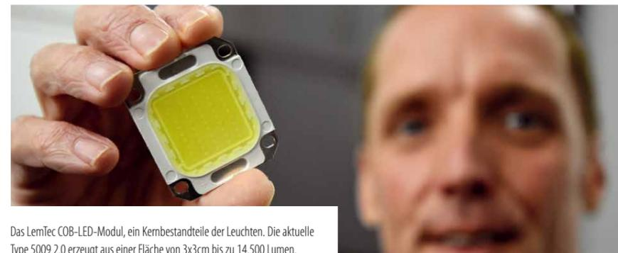
Das LemTec COB-LED-Modul, ein Kernbestandteil der Leuchten. Die aktuelle Type 5009 2.0 erzeugt aus einer Fläche von 3x3cm bis zu 14.500 Lumen.
