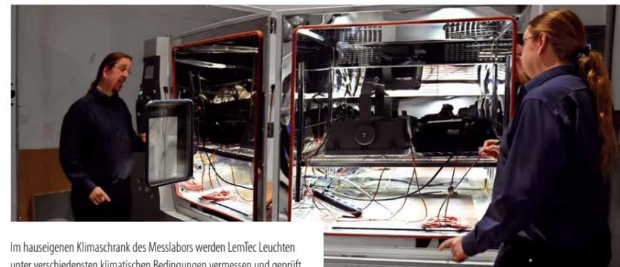
Im hauseigenen Klimaschrank des Messlabors werden LemTec Leuchten unter verschiedensten Klimatischen Bedingungen vermessen und geprüft.
